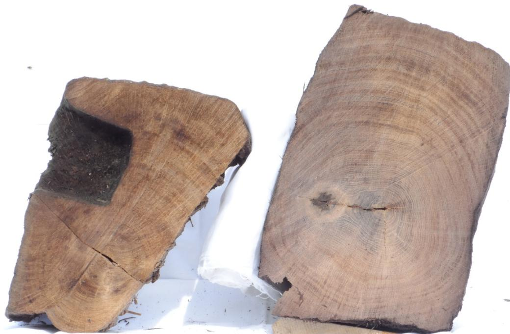
*Querschnitt der Eichenschwelle, die man im 16. Jahrhundert in die Lenne einbaute, hier abgebildet in der Schräglage wie im Flussbett vorhanden. Maße: rund 31 x 20 cm. Das linke Bruchstück zeigt eine Aushöhlung. Darin war ein Holz eingefügt, das in die ansteigend über der Schwelle aufgeschichteten Bruchsteine ragte. Diese Holzanker zwischen den Steinen verhinderten ein Wegkippen der Fußschwelle bei Unterspülung.*
