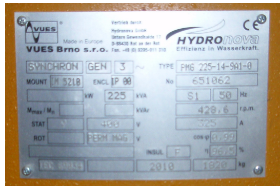
Daten des neuen Synchrongenerators
