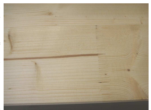
Kantholz mit verleimter Keilverzinkung
